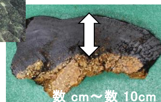
数 cm～数 10cm コバルトリッチクラストの断面
