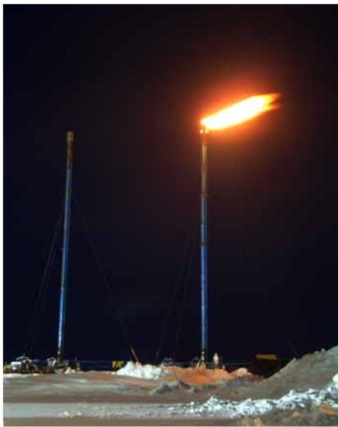
陸上産出試験現場 分解したガスを燃焼させたフレア
