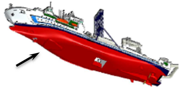
白嶺船底ドームに取り付けられたマルチビーム音響測探装置(MBES)
